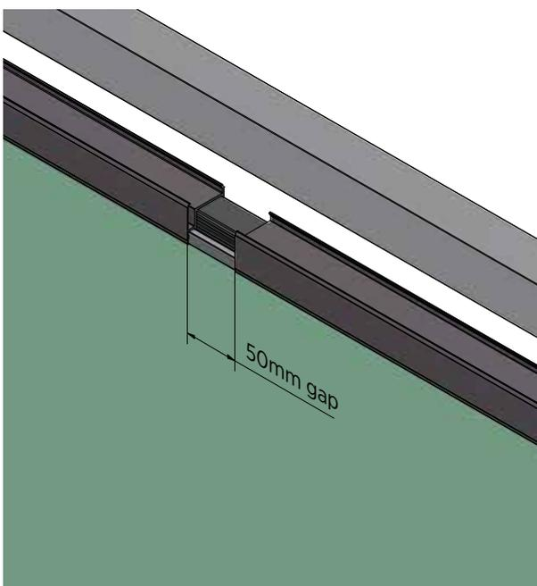
Ein Abstand von 50 mm ist erforderlich, um eine Beschädigung der LED und des Handlaufs aufgrund von wärmebedingter Dehnung und Kontraktion zu vermeiden.
