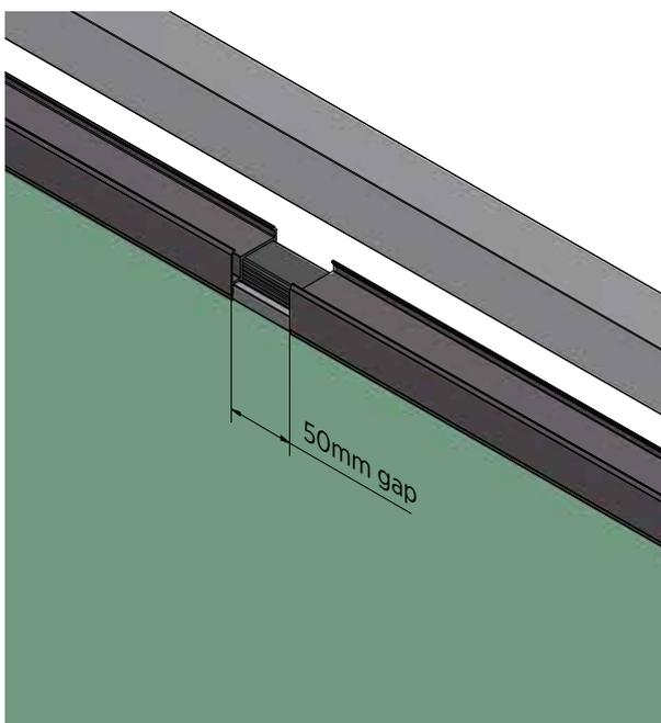
Un espace de 50 mm est nécessaire pour éviter d'endommager la LED et la main courante en raison de la dilatation et de la contraction thermiques.
